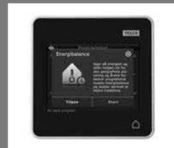
Das neue VELUX INTEGRA® Smartpad verfügt über einen Touchscreen, der eine intuitive Handhabung der elektrischen VELUX Produkte ermöglicht.
